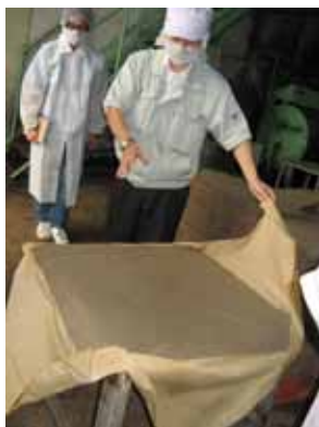
しょうゆかすの水分は38～45%程度まで絞る(35%以下にすると油分が出るので絞りすぎない)
