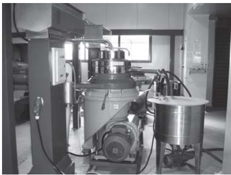
縦型遠心分離機で水と油に分ける。でき上がったオイルはステンレス製のタンクに保存
