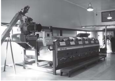
枝葉を取り除き洗浄後、実を破碎する。水を加えながら攪拌しペースト状にし、水平式の遠心分離(写真)機で液体(水・油)と固体に分ける
